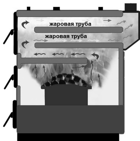
Рис. 4. Схема движения дымовых газов в трехходовом теплообменнике для котла VLK PRK 25-130.
