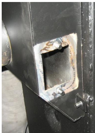
Рис. 10. Отверстие для чистки адаптера дымохода.
