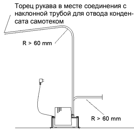
Рис. 5 Схема прокладки рукава
