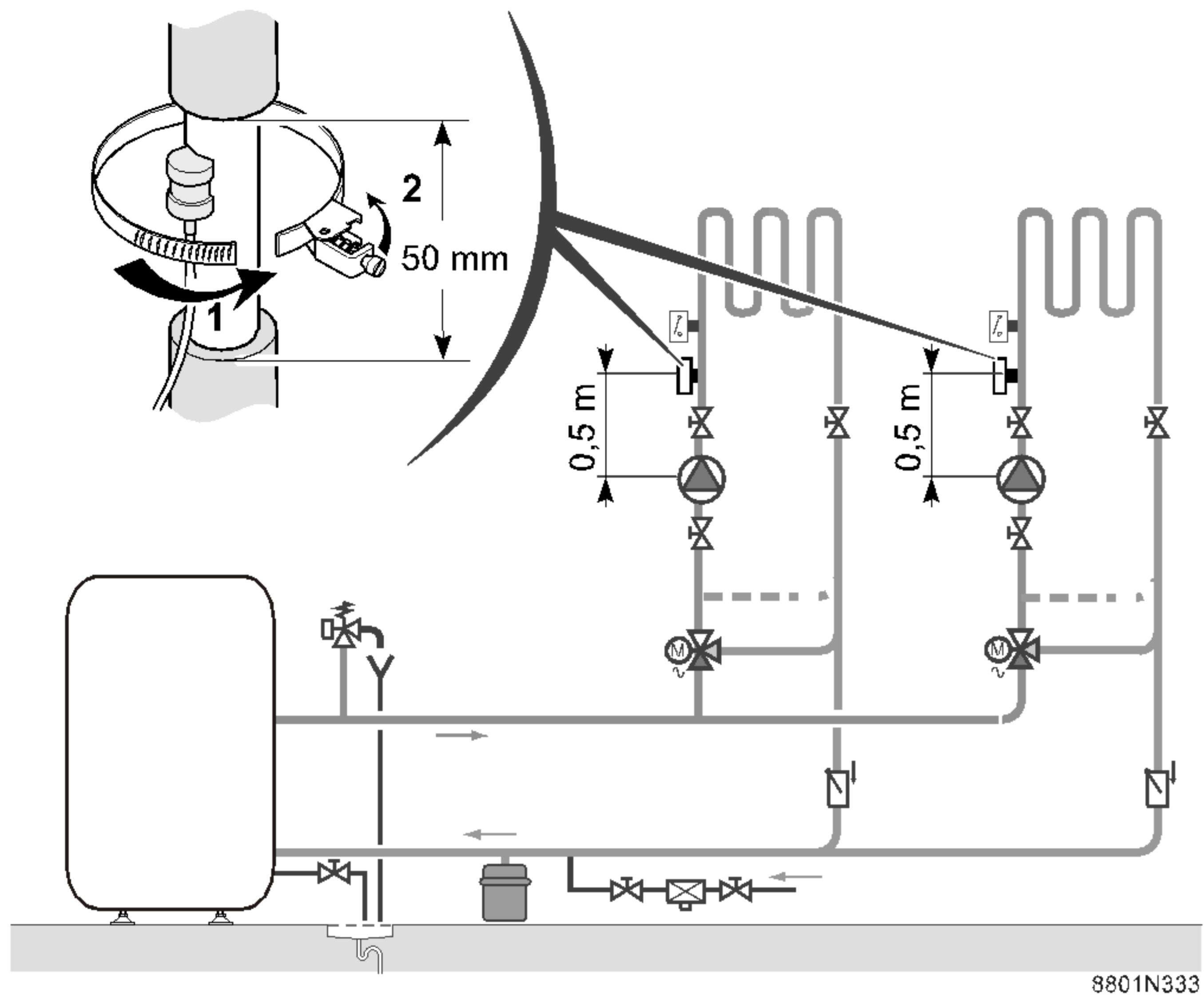
Датчик температуры подающей линии с соединительным кабелем (длиной 2.5 м) и разъемом для подключения устанавливается на подающем трубопроводе данного контура и должен быть подключен на предусмотренный разъем панели управления как описано ниже.
