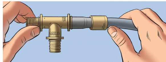
**2** Надеть гильзу на трубу фаской в сторону присоединяемого фитинга. Соединение следует монтировать на прямом участке трубы (без изгибов) минимальной длиной, равной трём гильзам. При расширении трубы гильза должна находиться на расстоянии от края трубы, равном длине минимум двух гильз.
