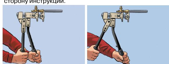
**3** Вставить в трубу расширитель до упора и произвести однократное расширение, сведя ручки расширителя. Развести ручки в исходное положение, повернуть расширитель на 30° и произвести повторное расширение.
