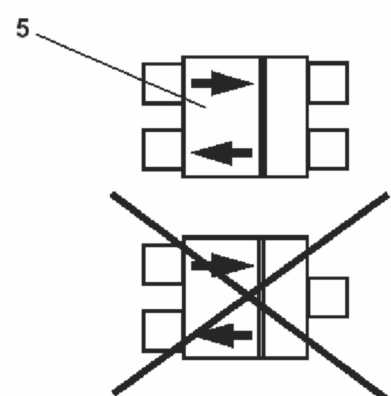
Переключающийся клапан (5) ставят так, чтобы циркуляция происходила в соответствии со стрелкой направления над приемным штуцером (Смотри на картинке). Включить сетевой выключатель.
