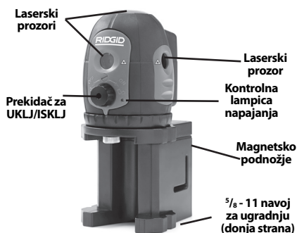
Slika 2 - Dijelovi laserskog nivelira
