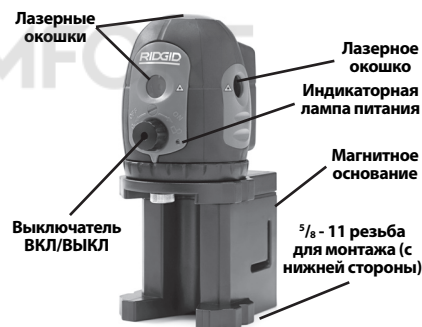
Рис. 2 - Детали лазера
