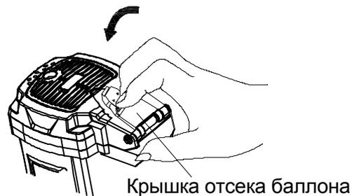
5. Закройте затвор крышки отсека баллона.
