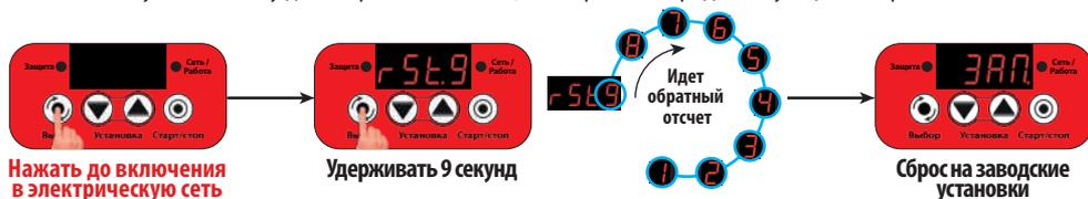
**Нажать до включения в электрическую сеть**
