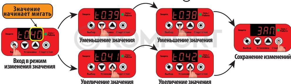
23.2 "oX.XX" – снижение давления для срабатывания защиты от опустошения системы. Если при включении подпитки давление в системе упадет на значение "oX.XX", то реле сразу прекратит подачу напряжения, а на дисплее будет отображаться "t.ПАУ↔XXXX"↔nt.XX", где "nt.XX" – количество оставшихся циклов работа/пауза, XXXX – оставшееся время до запуска РДЭ:
