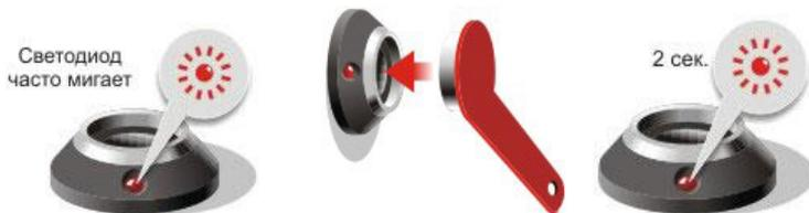
Если в течение 1 минуты никакие действия с электронными ключами не производились, сигнализация автоматически возвращается в нормальный режим работы.
