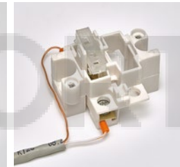
Фото 17. Подключение проводного выключателя
