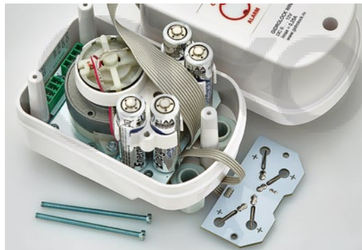
Фото 31. Контактная площадка снята, батарейки могут быть заменены
