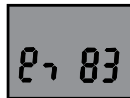
Рисунок 9. Индикация кода типа теплообменника
