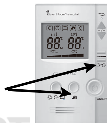
Рисунок 8. Настройка типа теплообменника
