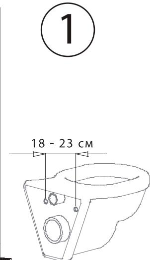
2. Учитывая толщину напольной плитки, определите высоту, на которую вы закрепите унитаз. После этого установите высоту несущих регулируемых ножек рамы. Определите расстояние между стеной и бачком. Затем отрегулируйте и зафиксируйте стенные соединительные части, как показано выше.
