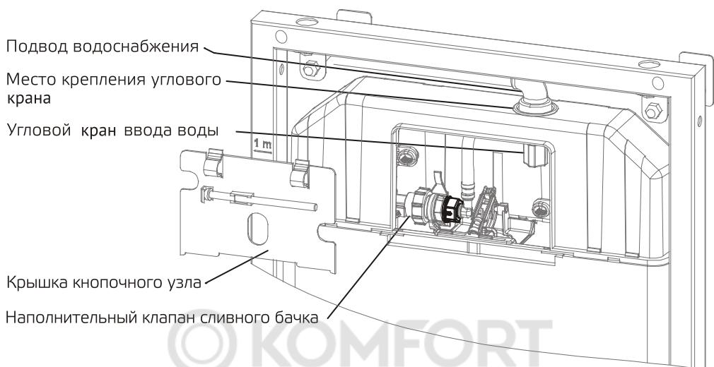
6. После выполнения всех этапов установки инсталляция теперь закреплена к стене и соединена с основной системой водоснабжения и канализации. Чтобы предотвратить проблемы загрязнения во время процесса цементирования или укладки плитки установите на время монтажа: заглушку впускной трубы, заглушку смыгвой трубы, защиту шпилек и защитный кожух кнопочного узла.
