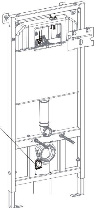
5. Аккуратно удалите крышку кнопочного узла. Соедините гибкую подводку воды с угловым краном, надежно соедините узел. Проверьте все соединения углового крана, чтобы предотвратить утечку и верните крышку кнопочного узла на место.
