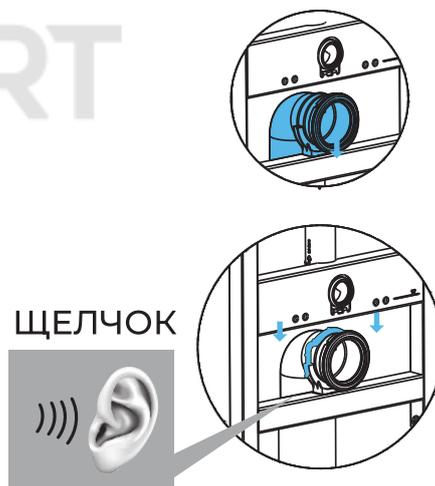
Установите канализационную трубу и закрепите ее фиксирующим зажимом.
