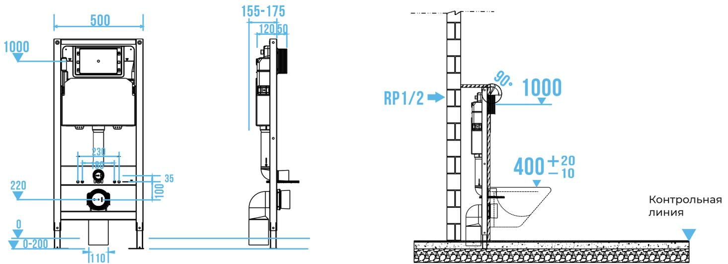
Выберите боковой или верхний подвод воды в зависимости от условий эксплуатации.
