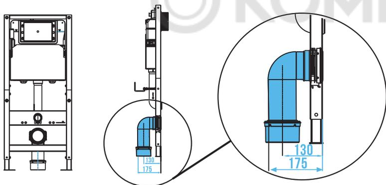
При установке первого зажима расстояние между центром канализационной трубы и передняя плоскость опоры должна составлять 130 мм.
