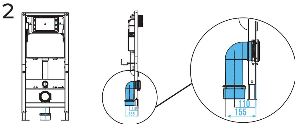
При установке второго зажима, расстояние между центром канализационной трубы и передней панелью опоры должно составлять 110 мм.
