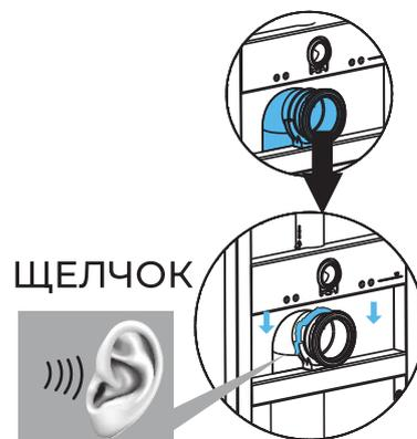
Установите канализационную трубу и закрепите ее фиксированным зажимом.
