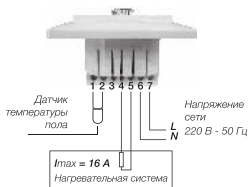
Рисунок 4. Схема подключения к терморегулятору
