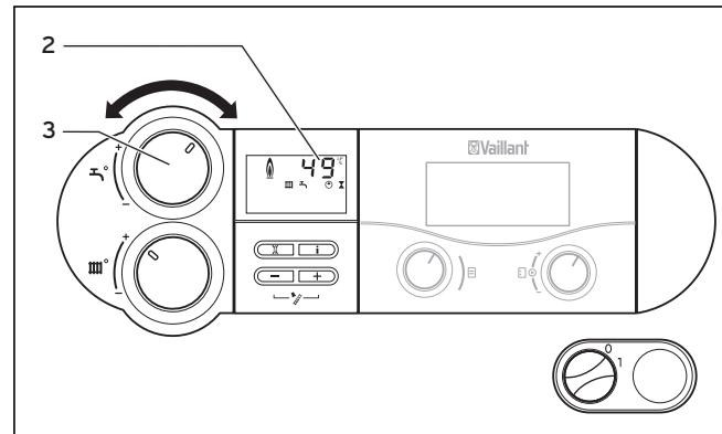
Рис. 4.6 Настройка температуры горячей воды
