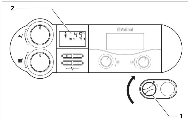
Рис. 4.4 Включение аппарата
