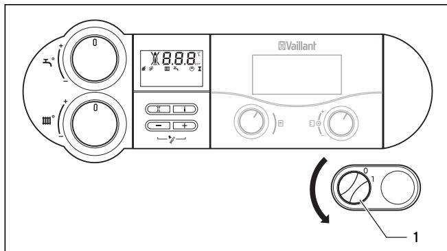
Рис. 4.13 Отключение прибора
