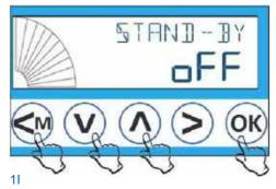
Можно предотвратить автоматическую или ручную регенерацию умягчителя. Эта функция полезна, например, при ожидании вмешательства техника после обнаружения неисправности.
