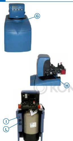
Снова установите колонну умягчителя в солевой бак G, уделяя особое внимание ячейке хлора H (BIO). Перед окончательной установкой умягчителя необходимо определить слив L для перелива и проходное отверстие всасывающей трубы I для рассола, которая будет соединена между клапаном рассола и головкой умягчителя.
