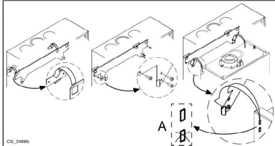
Предохранительный клапан ДОЛЖЕН быть подключен к сливному клапану в месте расположения отверстия "U" в основании короба так, чтобы избежать утечек из него.
