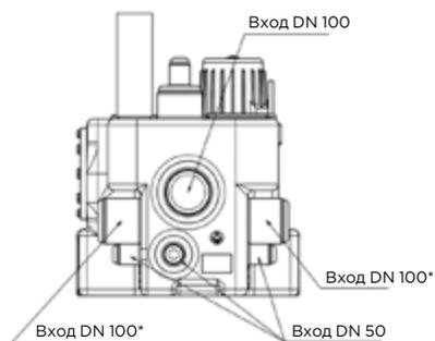
\* Этот вход должен быть выведен на высоту 250 мм над уровнем земли непосредственно над насосной станцией
