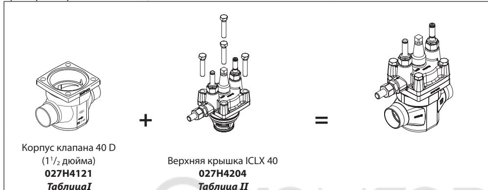
ICV 40 корпус клапана с различными штуцерами
