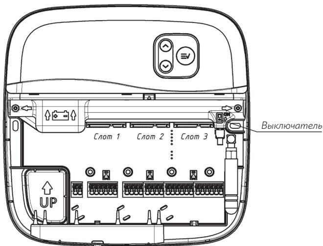
Рис. 3 Вид модуля со снятой крышкой
