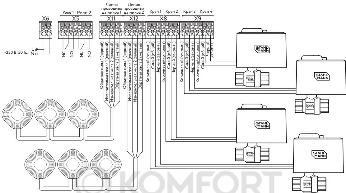
Рис. 4 Схема подключения кранов с электроприводом и датчиков протечки (последовательное подключение с контролем обрыва) к модулю управления Stahlmann Smart
