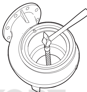
Рис. 21 Монтаж уплотнительного кольца
