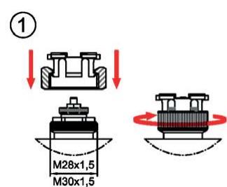
Togliere il cappuccio bianco presente sulla valvola o sul vitone della barra collettore. Inserire l'aggancio rapido sul vitone e avvitare la ghiera fino a fine corsa.
