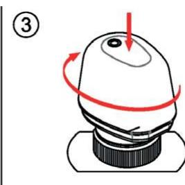
Mantenendo premuto l'attuatore verso l'aggancio rapido, ruotarlo in senso orario fino a fine corsa bloccandolo.
