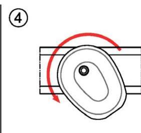
Per rimuovere l'attuatore elettrotermico dall'aggancio rapido sarà sufficiente ruotarlo in senso anti-orario.
