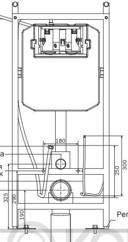
Установите систему инсталляции для подвесного унитаза и выведите шланг подачи воды и сетевой кабель из стены
