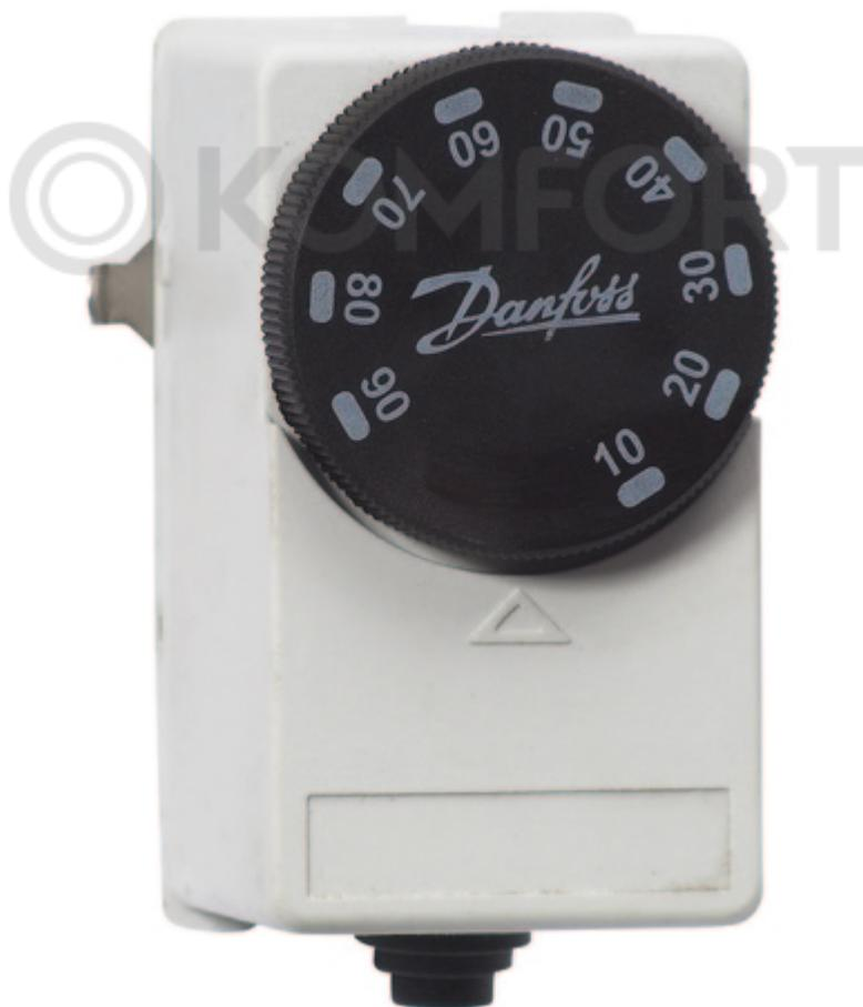
Термостат электромеханический типа АТФ предназначен для регулирования температуры в трубопроводе, крепится на трубе и поставляется в комплекте со специальным ремешком крепления. Термостат оснащен заполненным газом сильфоном, который обеспечивает надежное управление в широком интервале температур (10-90 °С). Наименьшее устанавливаемое значение 10 °С позволяет использовать термостат для защиты от замерзания.
