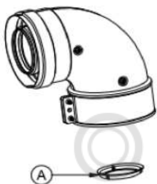
Присоединительные размеры при установке начального отвода 90° для моделей 18F, 24F, 1.24F
