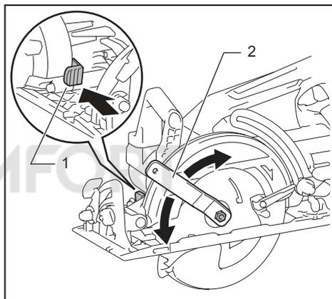
► 1. Фиксатор вала 2. Гачный ключ
