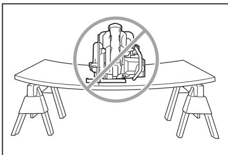
13. **Не используйте тупые или поврежденные диски.** Незаточенные или неправильно установленные диски приведут к узкому распилу, что вызовет чрезмерное трение, заклинивание диска и отдачу.
