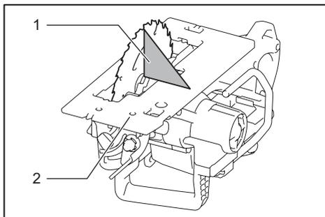
▶ 1. Треугольная линейка 2. Регулировочный болт
