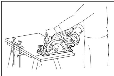
5. Если при выполнении работ существует риск контакта режущего инструмента со скрытой электропроводкой, держите электроинструмент только за специально предназначенные изолированные поверхности. Контакт с проводом под напряжением приведет к тому, что металлические детали инструмента также будут под напряжением, что приведет к поражению оператора электрическим током.
