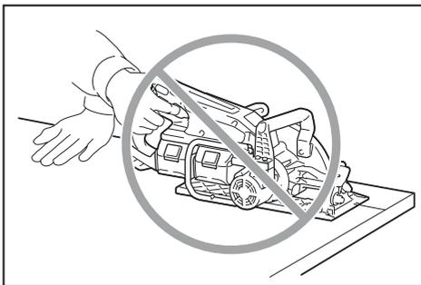
17. **Никогда не прилагайте повышенных усилий к пиле. Двигайте пилу вперед со скоростью, которая позволяет дисковой пиле пилить без снижения скорости.** Приложение повышенных усилий к дисковой пиле может привести к неравномерному распилу, снижению точности и возможной отдаче.
