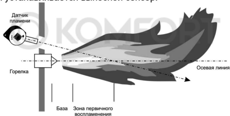
Расположение датчика относительно контролируемого пламени.
