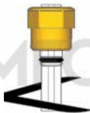
Для монтажа клапана R88I с отсекающим клапаном следует убедиться, что пластмассовый язычок не мешает установке. В противном случае, отрезать часть язычка, как показано на рисунке.
