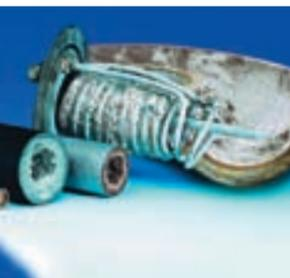
Жесткая вода содержит большое количество солей кальция и магния образующих на стенках трубопроводов и на нагревательных поверхностях известковые отложения. Без надежной защиты от известковых отложений ваши трубы, котлы, бойлеры или теплообменники не смогут долго выдерживать такие нагрузки. Возможные последствия этого — дорогостоящие ремонтные работы и возросшие затраты на электроэнергию.
