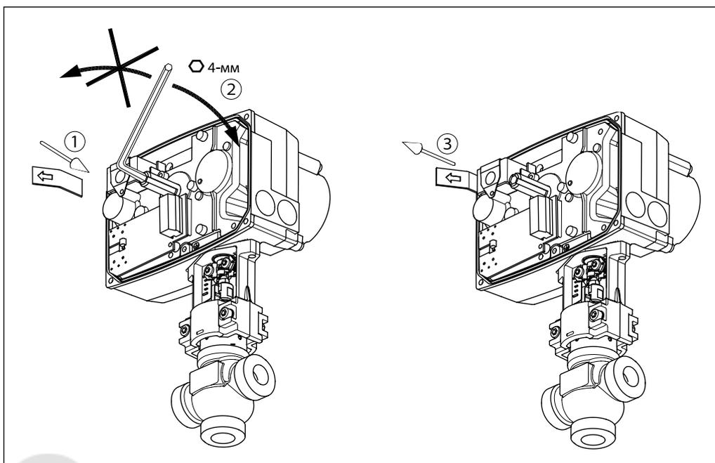
Ручное позиционирование осуществляется после снятия крышки и отключения питания вращением 4-мм шестигранного торцевого ключа (не входит в комплект поставки). При этом необходимо следить за направлением перемещения штока привода.
