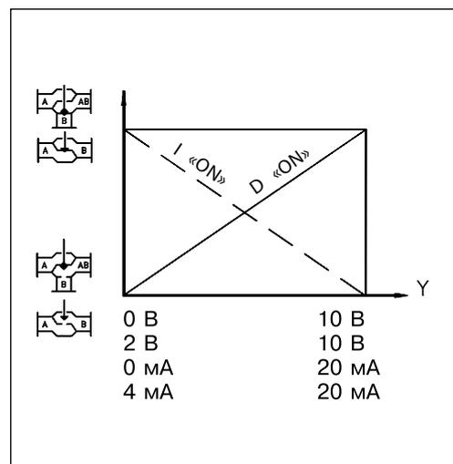
Электропривод оснащен блоком микропереключателей выбора функций DIP, который находится под съемной крышкой. В частности, если переключатель (6) поставлен в позицию «ON», электропривод начинает работать как трехпозиционный. Для подготовки привода к работе необходимо установить нужные положения переключателей.
