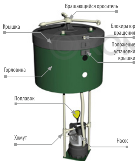
Рисунок 17. Установка циркуляционного насоса Станции.
