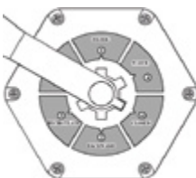
Рисунок 25. Режим вентиль закрыт.
