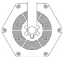
Рисунок 21. Режим промывки фильтра.
