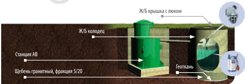
Рисунок 7. Система поглощения, колодец поглощения.
