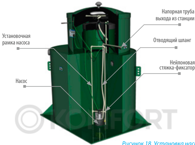
Рисунок 18. Установка насоса удаления воды камеры чистой воды.
