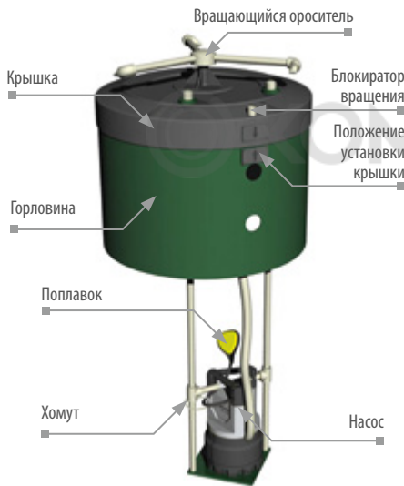
Рисунок 17. Установка циркуляционного насоса Станции.
