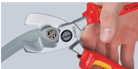
Вторичный рез: если требуется большее усилие (при резке проводов), возможна установка кабеля в профиль в режущих кромках у шарнира. Первичный рез — в переднем профиле, вторичный рез — в заднем при больших диаметрах кабеля сохраняется эргономичная ширина развода ручек.
