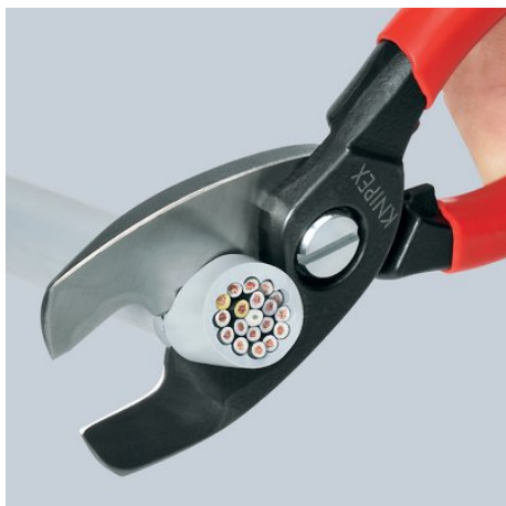
Вторичный рез: если требуется большее усилие (при резке проводов), возможна установка кабеля в профиль в режущих кромках у шарнира. Первичный рез — в переднем профиле, вторичный рез — в заднем при больших диаметрах кабеля сохраняется эргономичная ширина развода ручек.
