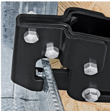
Установка инструмента на оба соединяемых профиля
