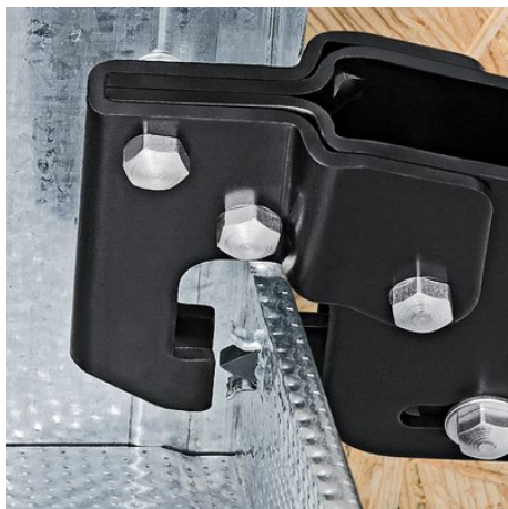
Пуансон инструмента продавливается через профили
