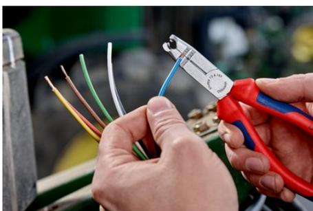
с отверстиями для удаления изоляции с проводов 1,5 и 2,5 мм<sup>2</sup>
