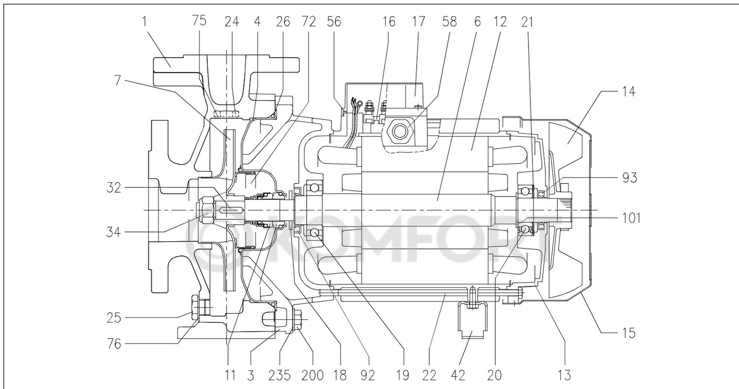
РАЗРЕЗ 3D 32, 40, 50, 65 — от 15 кВт и более
