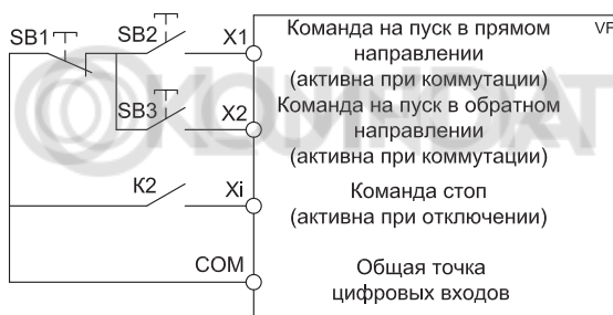
Рисунок 10.9-8. Трехпроводная схема управления 2
