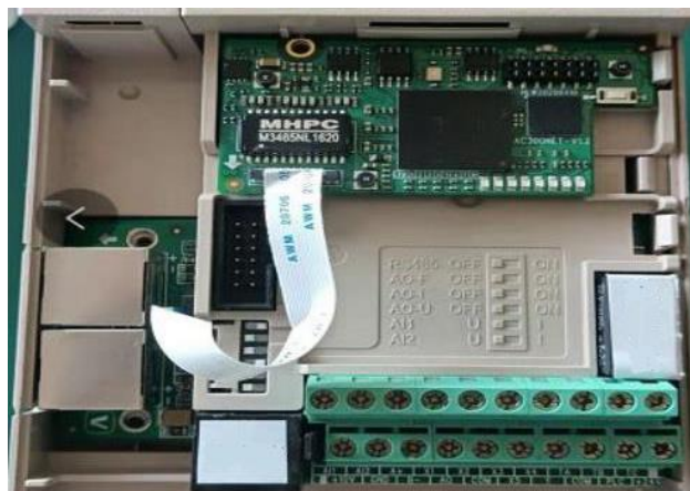
Рис. 7.2 Вариант установки на преобразователях частоты мощностью 2.2кВт-5.5кВт
