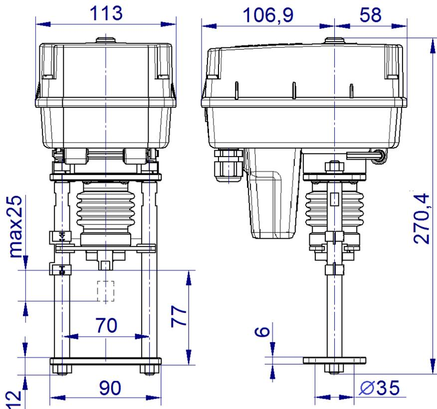
Рисунок А.2 - Электропривод TSL-1600-1T(R) во фланцевом исполнении
