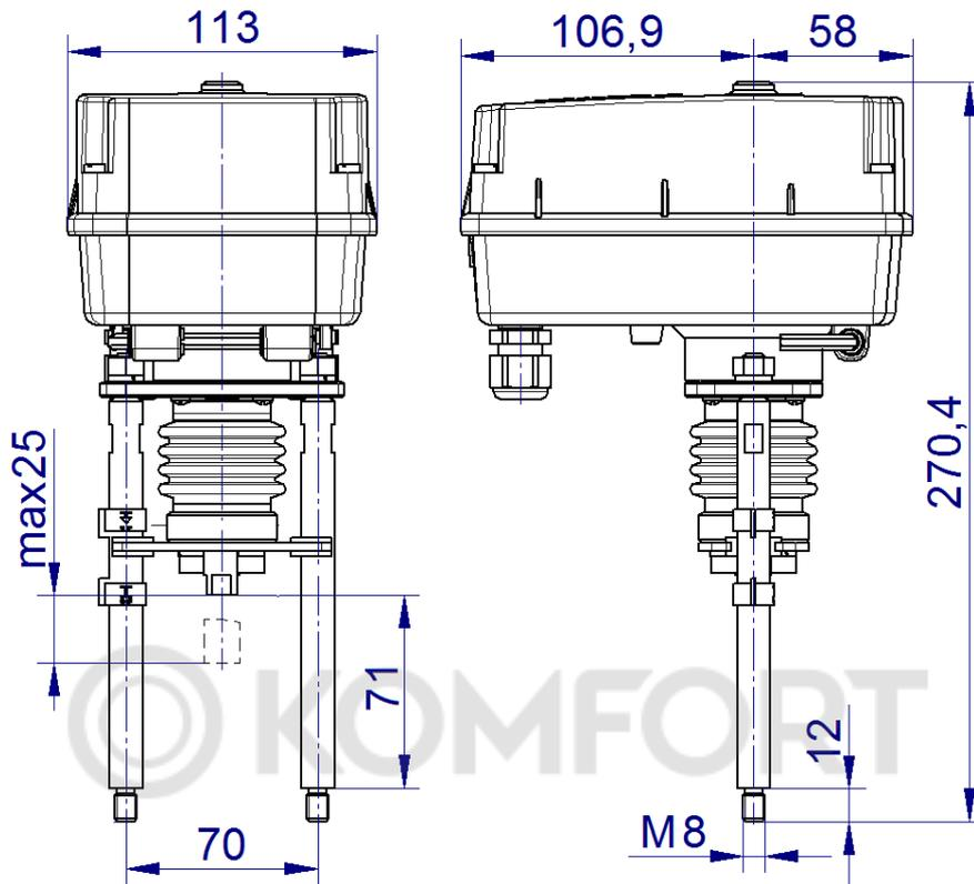
Рисунок А.1 - Электропривод TSL-1600-1T(R) в столбчатом исполнении
