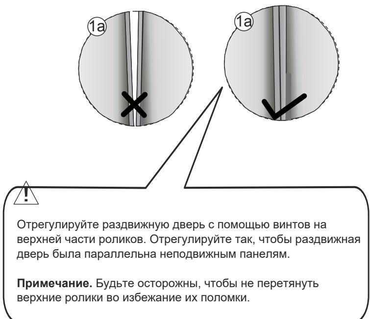
Отрегулируйте раздвижную дверь с помощью винтов на верхней части роликов. Отрегулируйте так, чтобы раздвижная дверь была параллельна неподвижным панелям.
