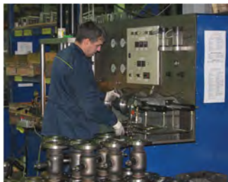
Тестирование шаровых кранов
