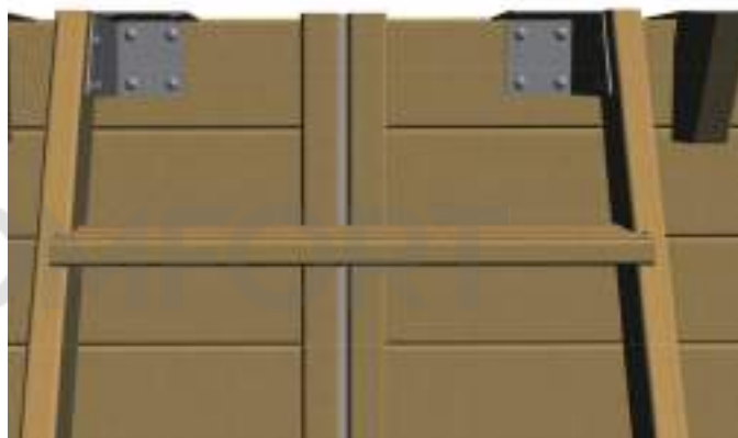
Крепление лестницы с наружной стороны бассейна
