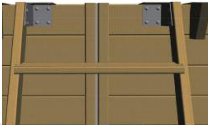
Figure 16 – Крепление лестницы с наружной стороны бассейна
