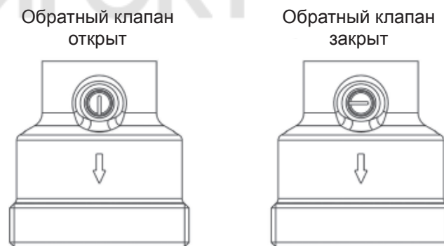
Рис. 3: Положения обратного клапана „Regumat“
